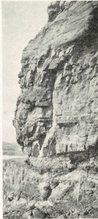
MYND 3. Tvörskurður undir Bergsleiti. Section at Bergsleiti (VI). A. Basalt (Blágrytishamrar). Basalt. B. Ljóst leir (banki). Light coloured clay. C. Kol (stabbin). Coal. D. Leir (rannin). Clay. E. Kol (kolbandið). Coal. F. Leir (fúrstin). Clay. G. Eyrgrýti. Fluv. conglomerate. H. Basalt. Basalt.
