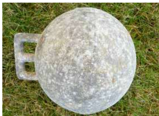
Foto 3. Aluminiumsbøje til fortøjningslinen
